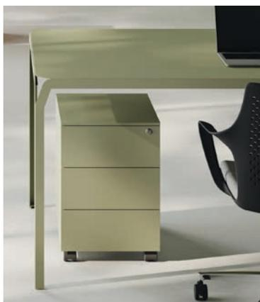
Le gambe sono realizzate in lamiera d'acciaio 30/10 di prima scelta DD11 - UNI EN10111, tagliate a laser e presso piegate. Dotate di appositi perni filettati per il montaggio al top. Verniciate a polveri elettrostatiche di resine epossipoliestere, previo trattamento di fosfosgrassaggio. Dotate di piedino di regolazione.
